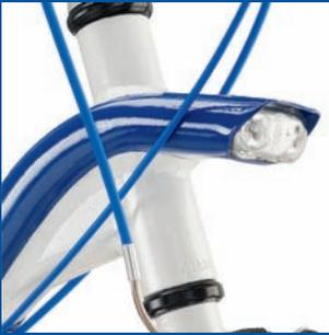
Il faro anteriore, integrato nel telaio idroformato, sfrutta la tecnologia led per assicurare la migliore illuminazione possibile dell'area nella direzione di marcia. Modernità e tradizione si uniscono nel design accattivante del faro, nella sua forma unica. La peculiarità del faro integrato nel telaio, inoltre, riprende una delle caratteristiche tecniche della Graziella degli anni '60 conferendo, al nuovo modello, un inconfondibile stile retrò.
